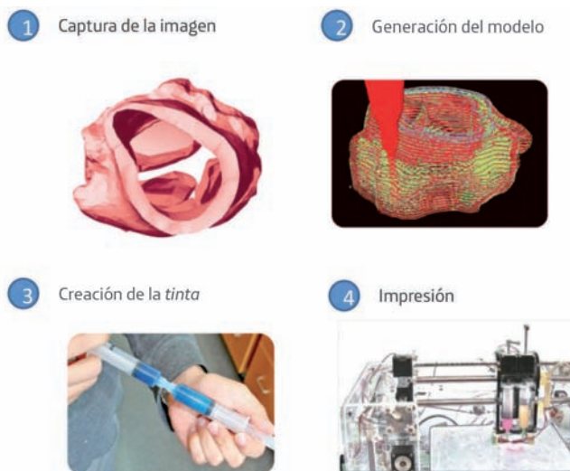
Figura 2.17 Modelo de bioimpresión 3D
