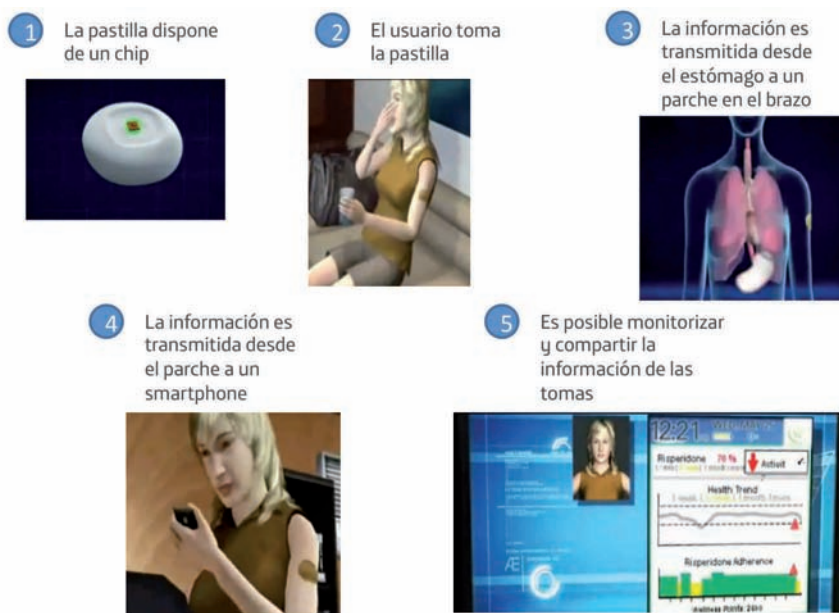
Figura 2.19 Funcionamiento de tecnología chip-in-a-pill
