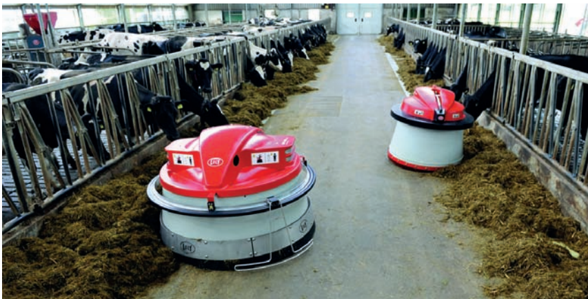
Figura 4.4 Robots de alimentación y ordeño Lely que automatizan estos procesos
