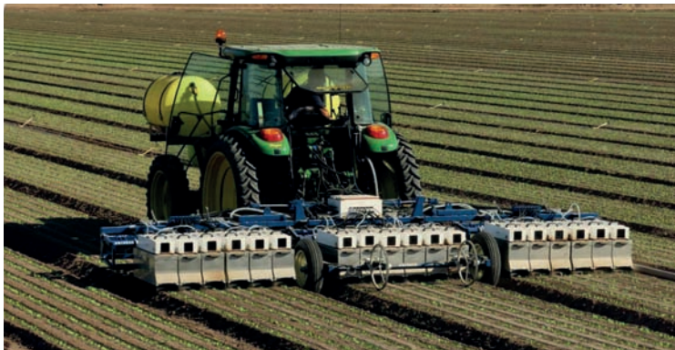
Figura 4.2 Sistemas automáticos de control de plantaciones de Blue River Technology
